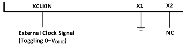
图 3-8 3.3V 外部振荡器的使用
